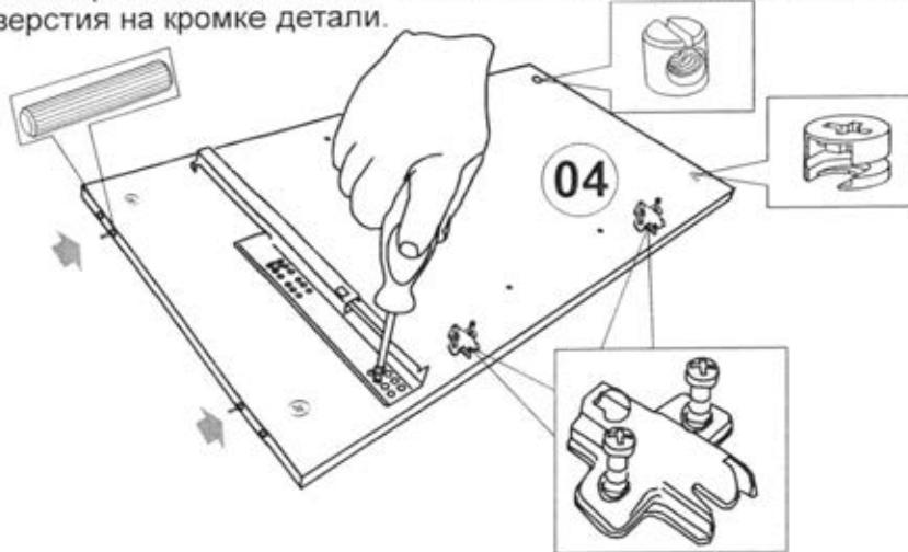
Стенку вертикальную 04 оборудовать роликовыми направляющими, совместив 3 и 6 отверстия на механизме с отверстиями на планке стенки вертикальной. Вставить винты 6,3x10 в отверстия и завернуть до упора. Стенку вертикальную 04 оборудовать пятью эксцентриками. В кромку деталей установить шканты. По имеющимся наколкам установить две монтажные планки D-0.
