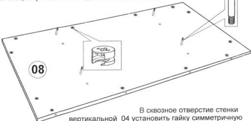
В сквозное отверстие стенки вертикальной 04 установить гайку симметричную таким образом, чтобы шлиц на гайке была направлена в сторону отверстия на кромке детали.
