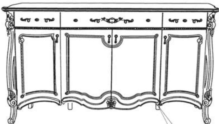
Установить комод в выбранное вами место. При необходимости при помощи опоры регулируемой добиться устойчивого положения комода. Для этого вставить крестообразную отвертку в отверстия в ножках. Вращением по часовой (против часовой) стрелки добиться требуемого результата .
