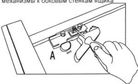
Механизм крепления позволяет регулировать положение ящика, после установки его в изделие, по высоте на 2,5 мм путем передвижения курсора А.
