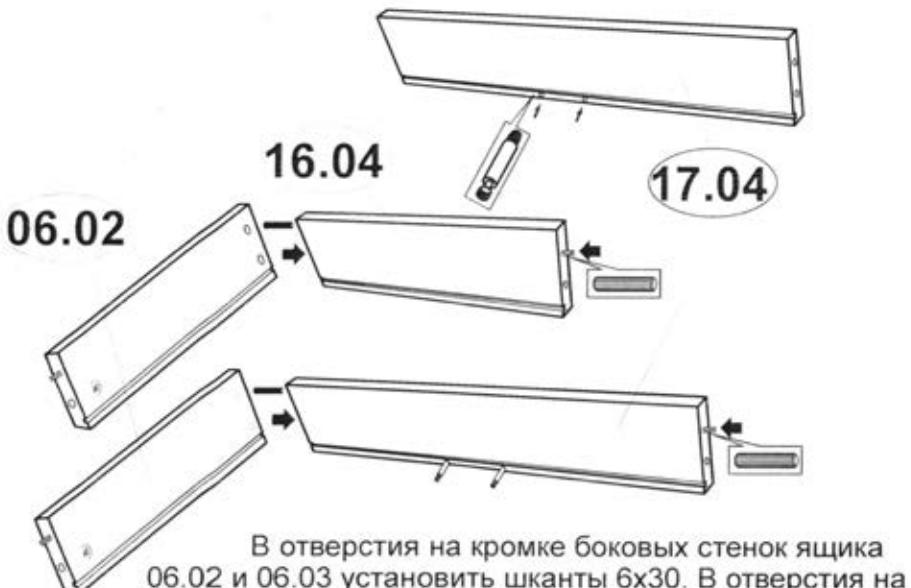
В отверстия на кромке боковых стенок ящика 06.02 и 06.03 установить шканты 6x30. В отверстия на пласти установить эксцентрики.
